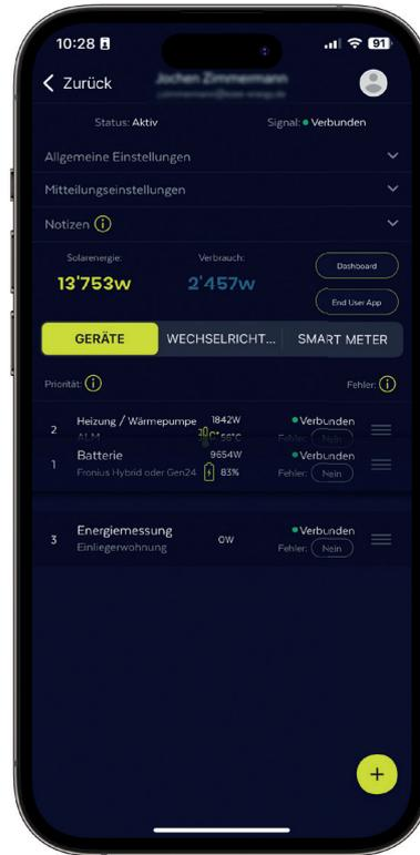
6. Wenn Sie alle Geräte erfasst haben, können Sie mittels Halten und Schieben ganz rechts die Priorität der Geräte verändern. Eine hohe Priorität bedeutet, dass dieses Gerät bevorzugt wird, wenn der überschüssige Solarstrom knapp ist.
