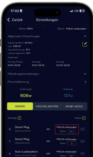
Sobald der Status des Geräts auf „Verbunden“ wechselt (siehe rote Box in obiger Abbildung), ist es einsatzbereit. Der erforderliche Reload dauert einige Sekunden.
