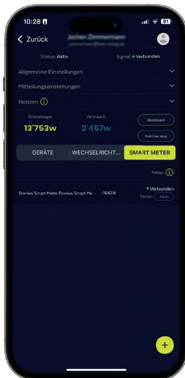
4. Gehen Sie für die Erfassung des Smart Meters gleich vor wie bei der Erfassung des Wechselrichters in den Schritten 1 bis 3. Klicken Sie anschließend auf „Weiter“.
