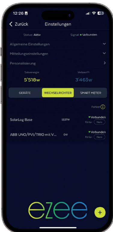
3. Der Wechselrichter wird in der Liste angezeigt. Während Sie die Installation vorbereiten, bleibt der Status des Geräts auf „nicht verbunden“. Erledigen Sie die Installation vor Ort beim Kunden, wechselt der Status nach kurzer Zeit auf „verbunden“. Erfassen Sie mittels „+“ einen zweiten Wechselrichter oder klicken Sie auf „Weiter“.
