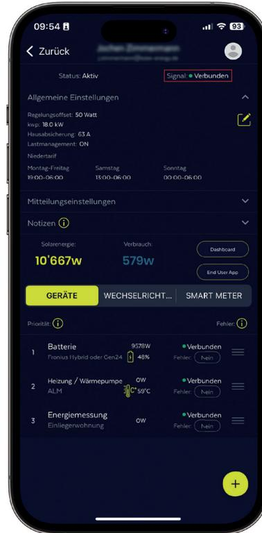
Sie gelangen auf die Übersichtsseite Ihres Kunden. Sobald der ezee Master korrekt angeschlossen ist, wechselt die Statusanzeige „Signal“ (siehe rote Box in obiger Abbildung) nach maximal einer Minute auf „Verbunden“ (Reload notwendig).
